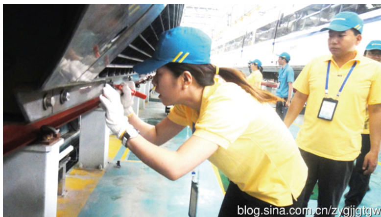
图1：二级修无电状态下车底作业
