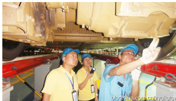
图2：一级修无电状态下车底作业
